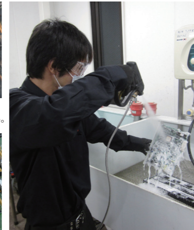
精密洗浄作業の様子
