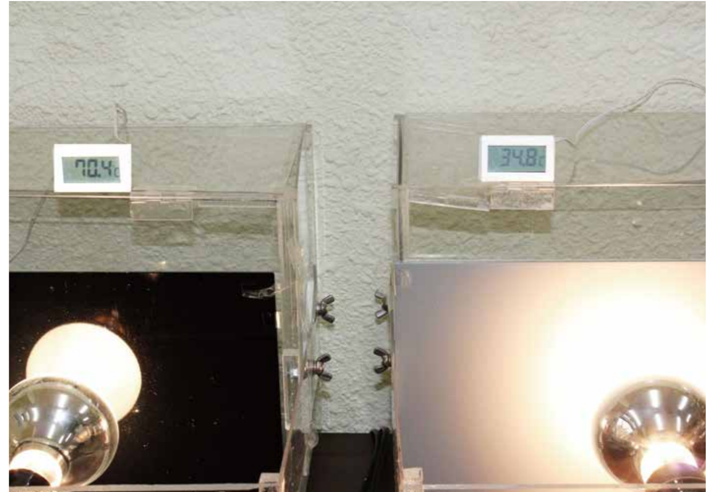
現在進行中の「ヒートアイランド対策」 左が未処理のアルミ板。右がシルバーコートしたアルミ板。10分程度でこの温度差になる。
